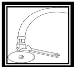
3.- Conecte el Adaptador Metálico en "T", utilice cinta de teflón para la conexión (no suministrado).
