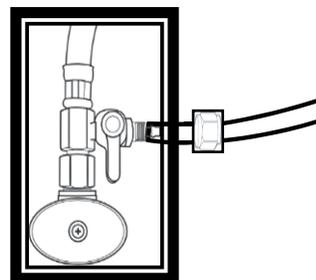
5.- Introduzca la manguera dentro del Adaptador Metálico en "T" y apriete la tuerca firmemente.
